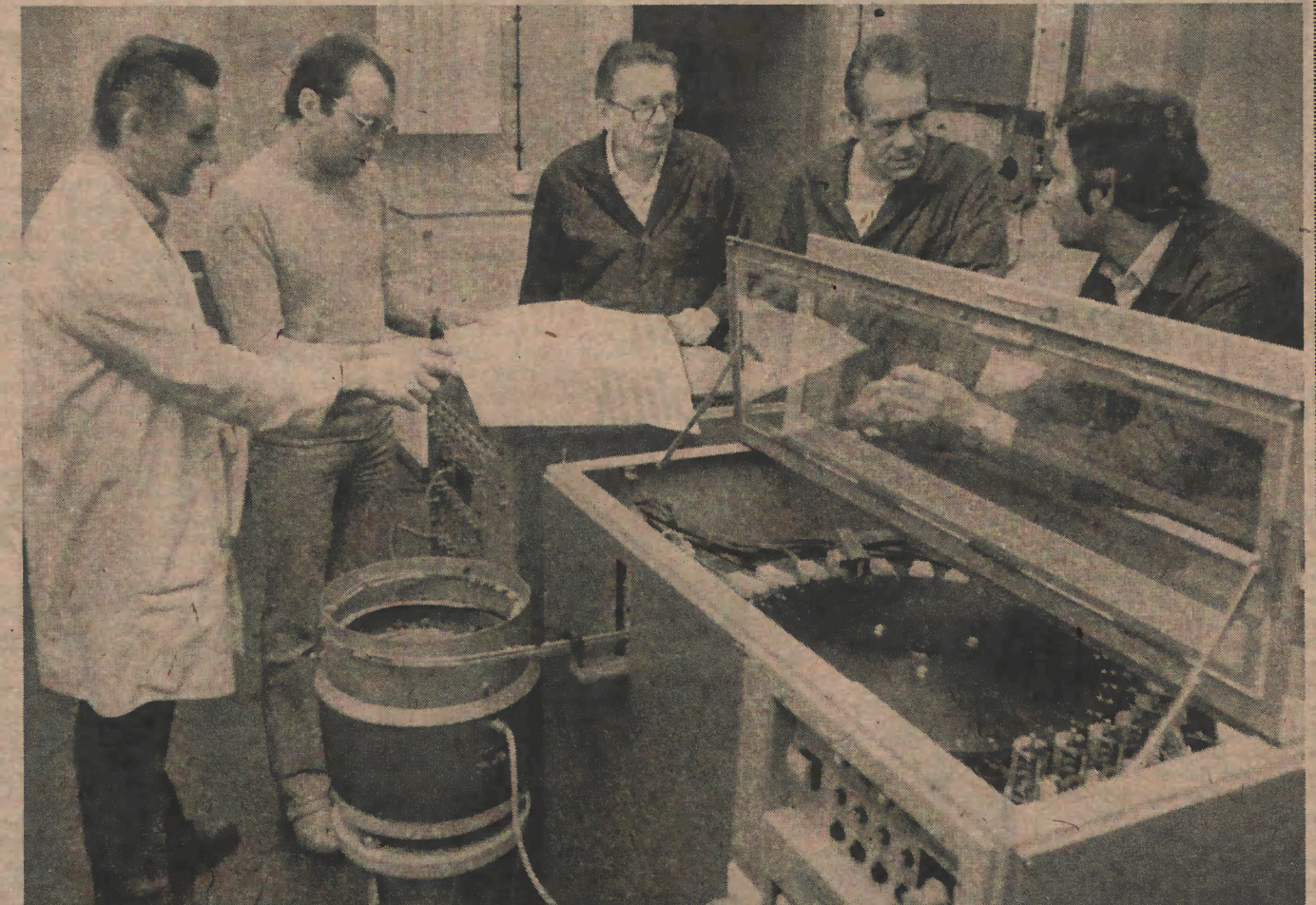
Gemeinsame Funktionserprobung des neuen Meßautomaten. Entwickler, Konstrukteure und Mechaniker arbeiteten hier eng mit dem künftigen Anwender zusammen. Foto: Knoblach
