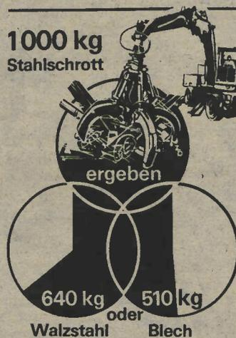
Da Sekundärrohstoffe in weitgehend veredelter Form vorliegen, ist es möglich, technologische Prozeßstufen einzusparen. Setzt man anstelle von Roheisen für die Stahlproduktion Schrott ein, so sind wesentlich höhere Schmelzleistungen möglich.
