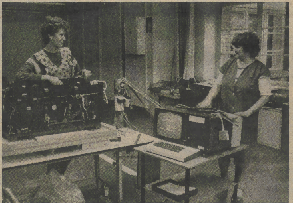
Die Kolleginnen Elke Lehmann (l.) und Sabine Schönfeld in der Endmontage der Kopiergeräteproduktion bei Secura. Mit einem im eigenen Rationalisierungsmittelbau hergestellten Prüfgerät (r.) wird der Kabelbaum des Kopiergerätes „Secop 3014 R“ geprüft.
