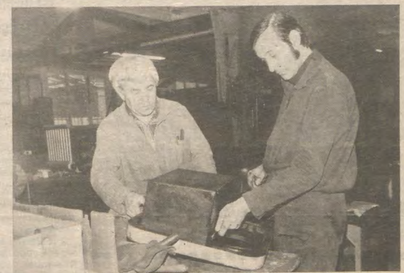
Werner Schlei und Michael Opitz (v. l. n. r.) gehören zum Kollektiv TAT/Ra der Instandhaltung des T-Bereiches. Auf unserem Foto sind sie bei der Reparatur einer Vakuumpumpe für OFO/Tr.
