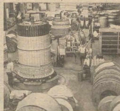
Mit der Einführung der Vertikalwickelmaschinen im Rahmen der komplexen Rationalisierung des Trafobaus konnte die Arbeitsproduktivität wesentlich gesteigert werden.
