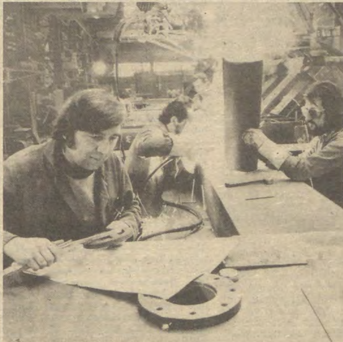
Hier entstehen Stirnwände für die Großtransformatoren. Unser Foto zeigt Mitglieder der Brigade „Edgar André“ des Betriebsteiles Niederschönhausen.
