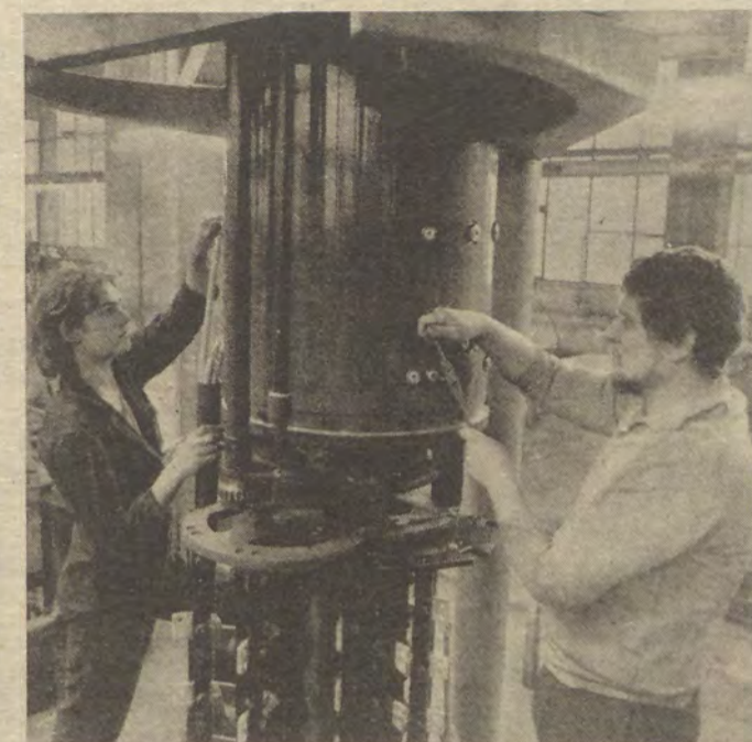
Blick in den Stufenschalterbau.
