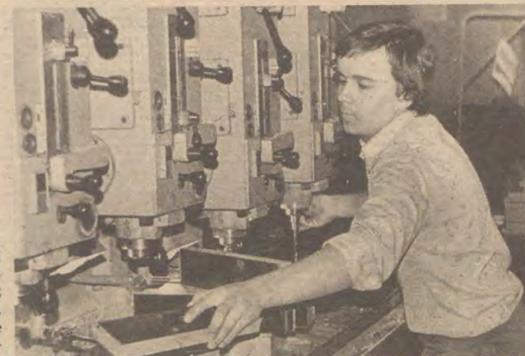
Frank Treffkorn, Lehrling im 2. Lehrjahr, an der sechsspindigen Reihenbohrmaschine zum Bohren von Hartpapierplatten für Co-Co-Lok-Transformatoren. Frank Treffkorn möchte nach Beendigung seiner Lehre im Bereich der Tischlerei bleiben.
