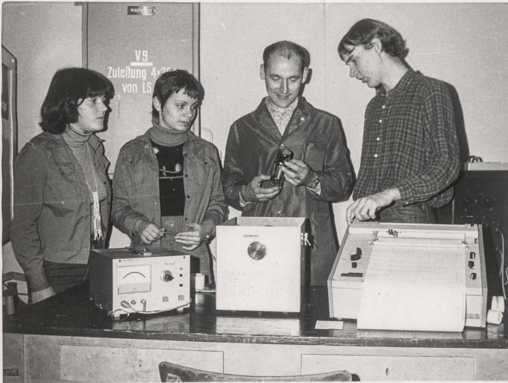
Die wpa-Schülergruppe an ihrer Meßeinrichtung zur Untersuchung der Instabilität des Anodenstromes von SEV MMFVCS20
